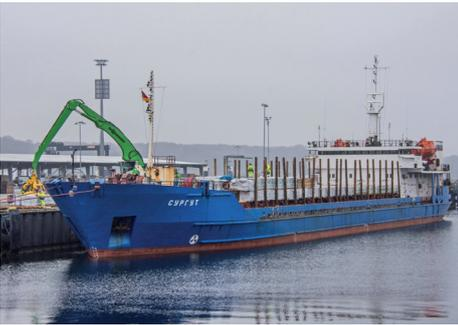
Eine Schiffsladung wird in der Regel binnen zweier Tage von den Kollegen der SEEHAFEN KIEL Stevedoring mittels Greifer gelöscht und in verschiedenen Hafenschuppen eingelagert. Die Zustellung der Ware erfolgt dann meist noch per Lkw, in zunehmenden Maße aber auch schon auf Waggon mit der Bahn.
